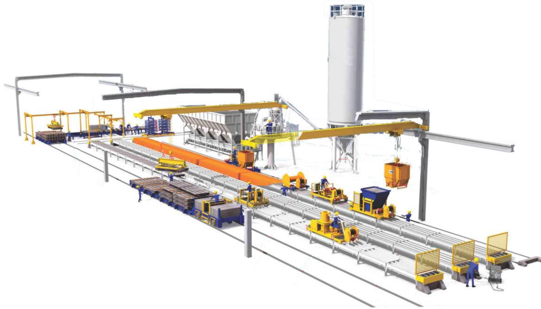
Figura 20 – Esquemático Fabrica de Dormentes de Concreto
